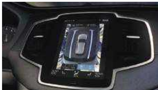
Hình 7: Góc nhìn 360 độ nhờ camera quanh xe của Volvo XC90 Figure 7: vision of 360° by cameras on Volvo XC90
