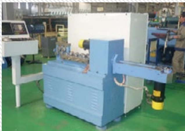
Hình 3: Máy uốn thép dây CNC do 4 kỹ sư và thợ trung cấp công ty cơ khí thiết kế, chế tạo
