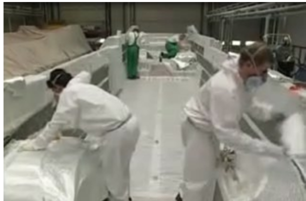
Hình 6: Thi công trải sợi khối sàn dưới
