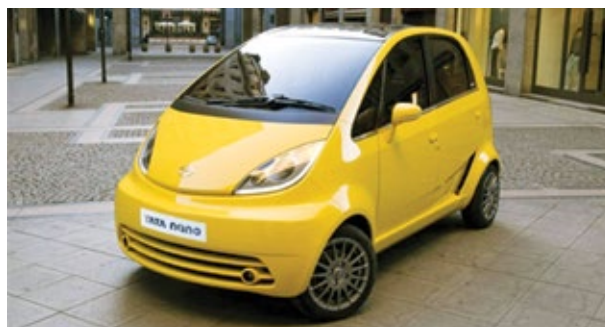
Hình 3: Xe Tata Nano của hãng Tata Motors (Ấn Độ) với thân vỏ làm bằng vật liệu composite sợi thủy tinh Figure 3: Tata Nano car of Tata Motors (India) with the trunk made of composite glass fibers
