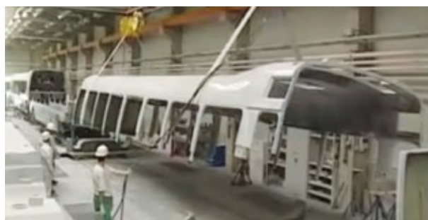
Hình 7b: Khối mũi trên sau khi đã tháo khuôn và hoàn chỉnh Figure 7b: The upper roof after getting its molds stripped off and final assembly
