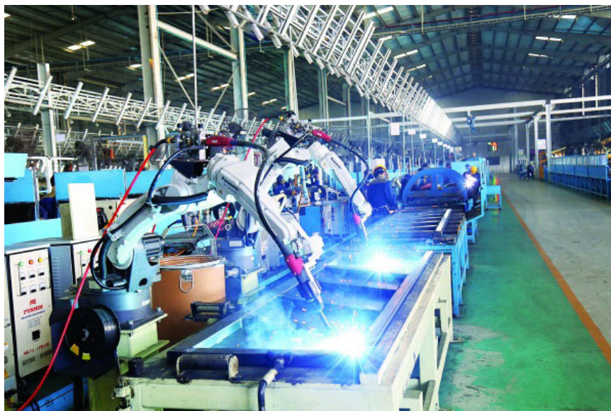
Hình 2: Công nghệ hàn robot tại Công ty Cơ khí (THACO)
