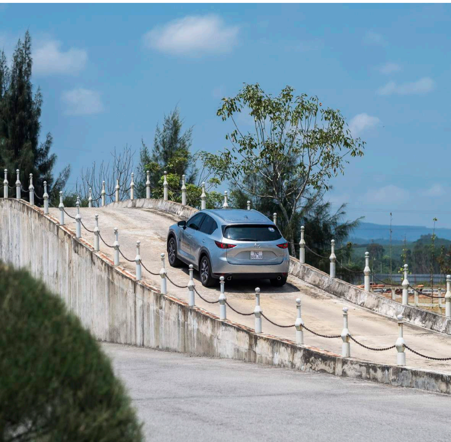
Đoạn đường vượt dốc dài 70 mét và có độ nghiêng khoảng 45 độ. The uphill test track has the length of 70 meters and inclination of 45 degrees.
