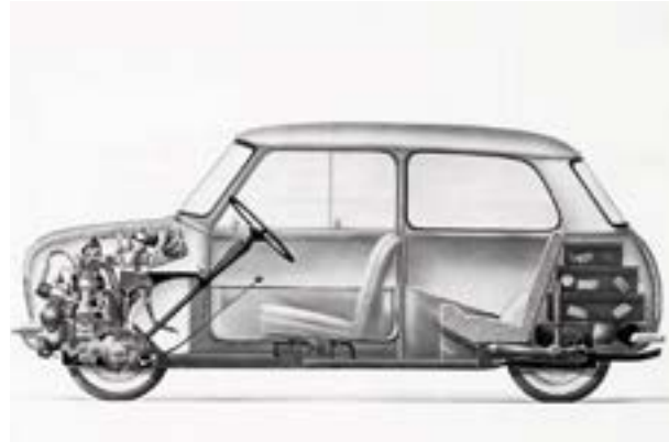
Internal structure of a Mini Classic
